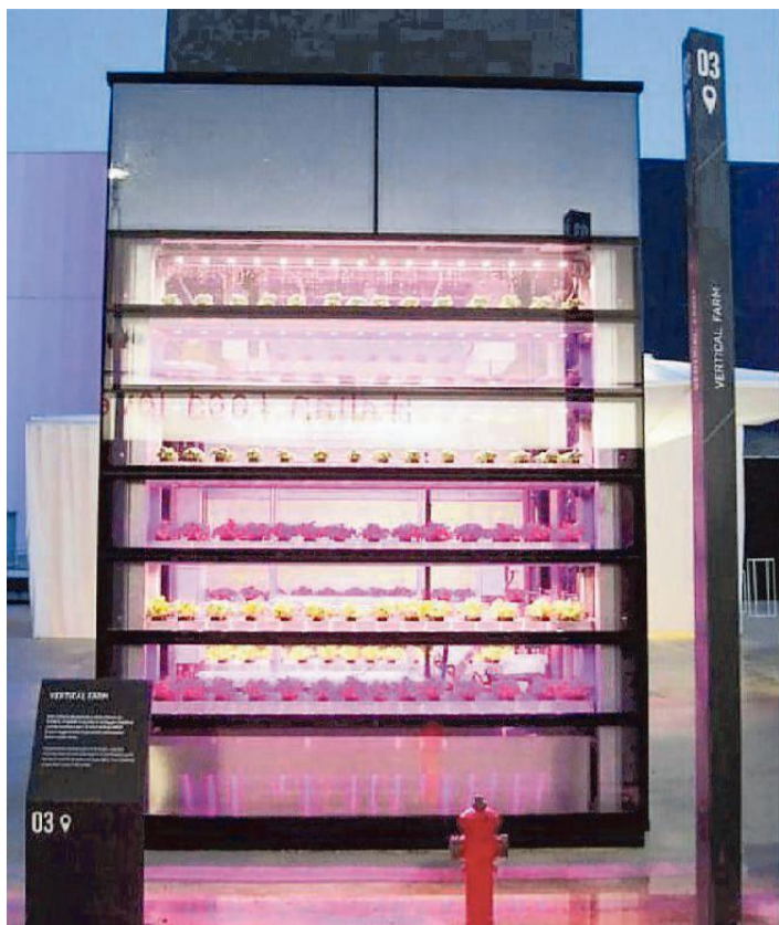
Esempio di coltivazione in verticale, fuori suolo, senza usare insetticidi in ambienti con luce a led e con un software che gestisce irrigazione e condizionamento dell'aria. A destra la firma del protocollo (FOTO BIANCHI)
